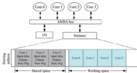
图 1 Leon3 四核处理器共享存储架构示意图
