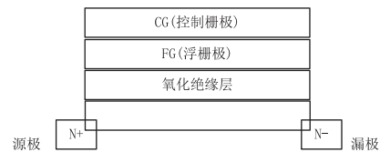
图 1 NAND Flash 存储单元结构
