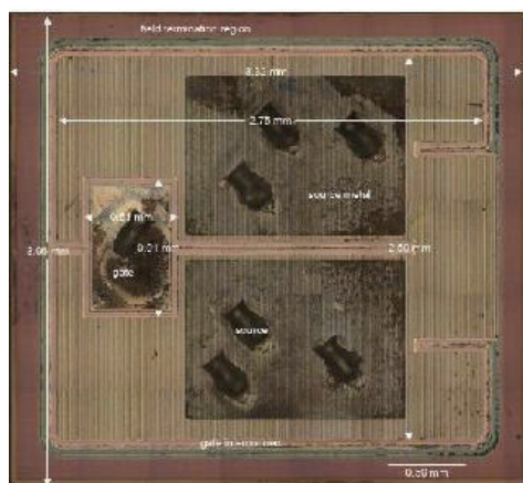
图 1 器件结构图（显微镜下）
