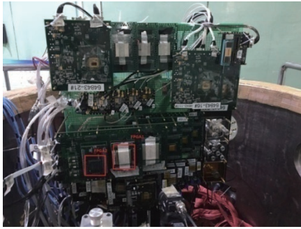
(b) BQR5V 系列 SRAM 型 FPGA 刷新评估系统实验图
